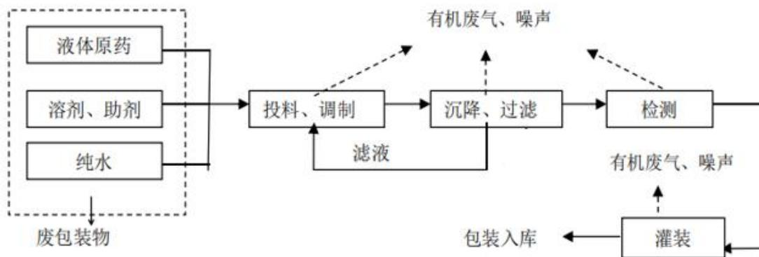
图 2.2.5 微乳剂、悬浮种衣剂生产工艺流程及产污环节图
