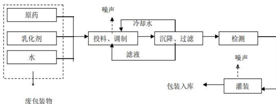
图 2.2-3 水剂生产工艺流程及产污环节图
