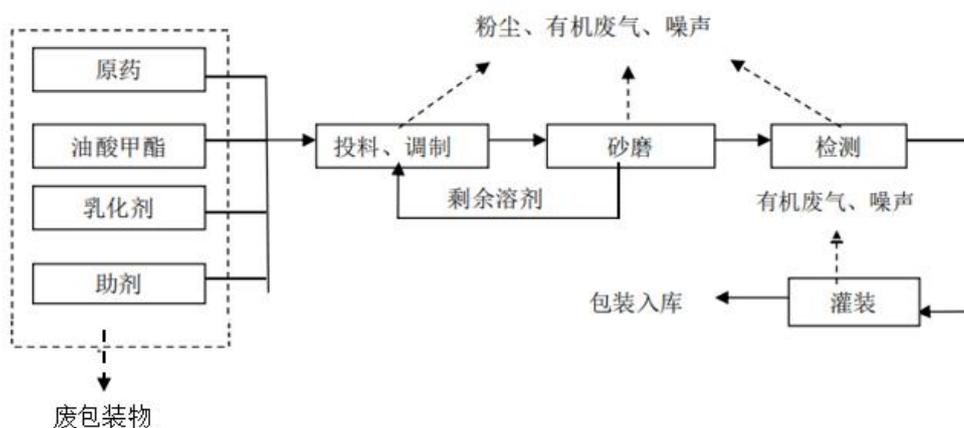
图 2.2.4 悬浮剂、悬乳剂生产工艺流程及产污环节图
