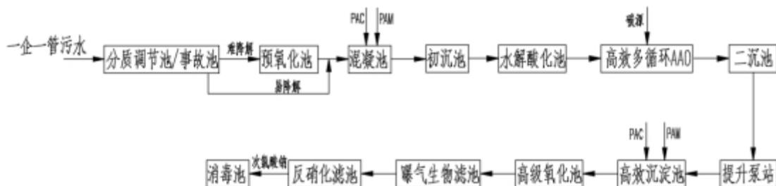
图 5.2-1 宁阳中辰水务有限公司污水处理工艺流程图
