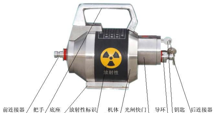
图8-1 典型 \gamma 射线探伤机结构示意图
